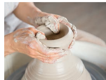
土のクセを殺す「土殺し」という下準備を行った後、電動ろくろを使って手早く美しく成型していく。
